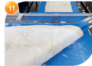
11 Z字形面带转弯设计 Z type corner design
