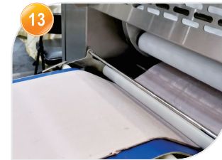
13 第二道12支行星轮压面 Key point kneading process (12 pcs roller design)
